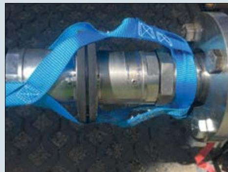
Die Industrie verwendet vermehrt flüssige Gase. Diese werden in Tanks angeliefert und anschließend in stationäre Behälter umgeladen. Bei der Be- und Entladung kommen elastische Schlauchleitungen zum Einsatz, die für die Verladung unter hohem Druck geeignet sind. Aufgrund des beträchtlichen Temperaturunterschieds, des hohen Betriebsdrucks und dem rauen Handling unterliegen sie einer starken Belastung.
